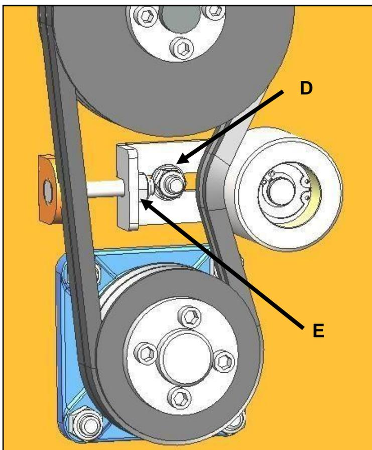
Vérifier qu'il n'y a pas de graisse sur les poulies et courroies (Usures prématurées). Vérifier l'alignement des courroies.
