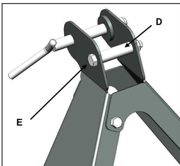
Monter l'entretoise (D) à l'aide d'une vis 12x90 (E) et un écrou frein fournis.
